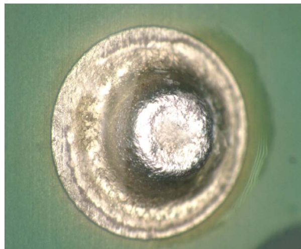
Lötstelle Aussenleiter Pin Soldering outer contact pin
