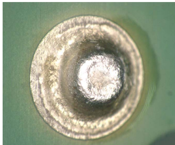
Lötstelle Aussenleiter Pin Soldering outer contact pin
